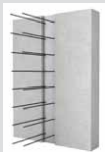
armování druhé části konstrukce
