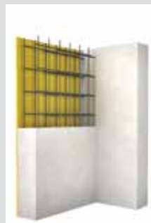
odlévání druhé části konstrukce
