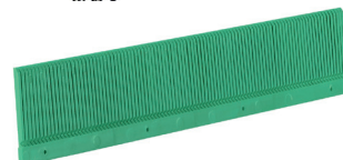
Bednicí hřeben vyroben, šíře 60 mm, délka 400 mm. Používá se v kombinaci s bednicím prvkem pro pracovní spáru např. ABS plech.
