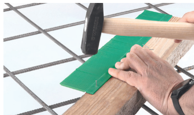
Bednicí hřeben vyroben, šíře 60 mm, délka 400 mm. Používá se v kombinaci s bednicím prvkem pro pracovní spáru např. ABS plech.
