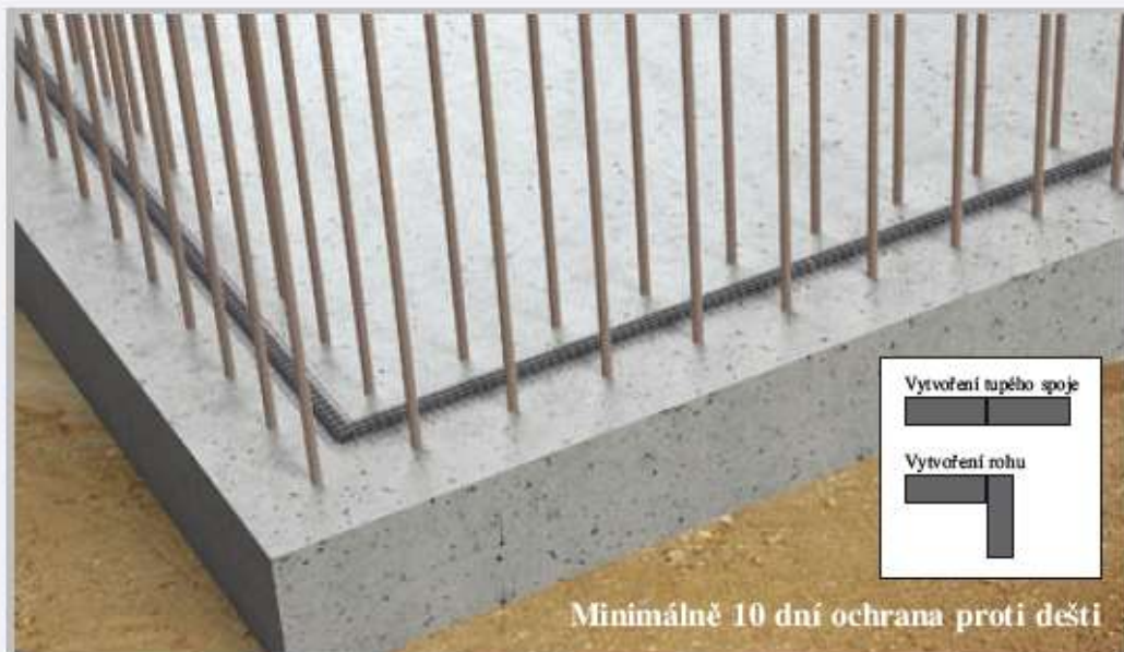
Montáž pásu MASTERSTOP LONG TIME s mřížkou na bobtnající pásy 8cm betonová krycí vrstva uvnitř výztuže
