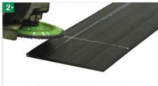
Zbroušení pásu pomocí brusky a brusného kotouče
