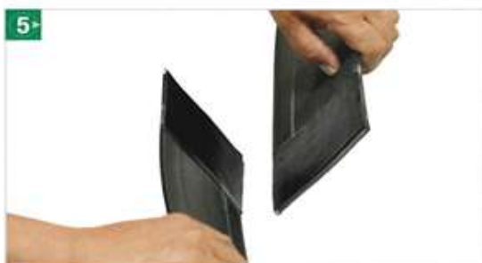
Lepicí páska se musí aplikovat na oba spojované konce pásu. Tyto konce se k sobě přitlačí a zajistí sponkou.
