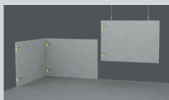
Sestavení prefabrikátů na staveništi
