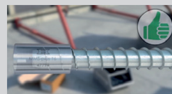
Při kontrole šroub se nesmí pouzdem protáhnout.
