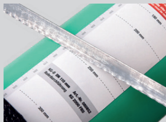
Pomocí nalepeného měřítka lze průchodku zkrátit na požadovanou délku.
