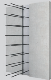
armování druhé části konstrukce
