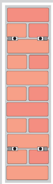
Schéma vložení výztuže do drážek - „řez stěnou“
